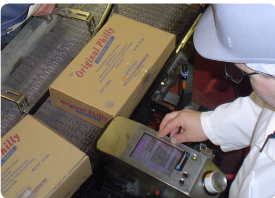
A tela sensível ao toque pré-carregada da 2300 da Videojet permite trocas simples
